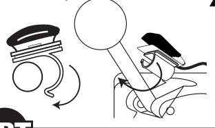
BE SURE TO FULLY ENGAGE THE NOTE: SPIGOT SWITCH JACK TO THE FLAVOR KEYPAD JACK FOR NORMAL BURST™ OPERATION. DO NOT NEGLECT TO CHECK THIS CONNECTION DURING DAILY STARTUP.
