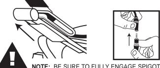
NOTE: BE SURE TO FULLY ENGAGE SPIGOT SWITCH JACK TO THE FLAVOR BURST™ KEYPAD JACK FOR NORMAL OPERATION. DO NOT NEGLECT TO CHECK CONNECTION DURING DAILY STARTUP.
